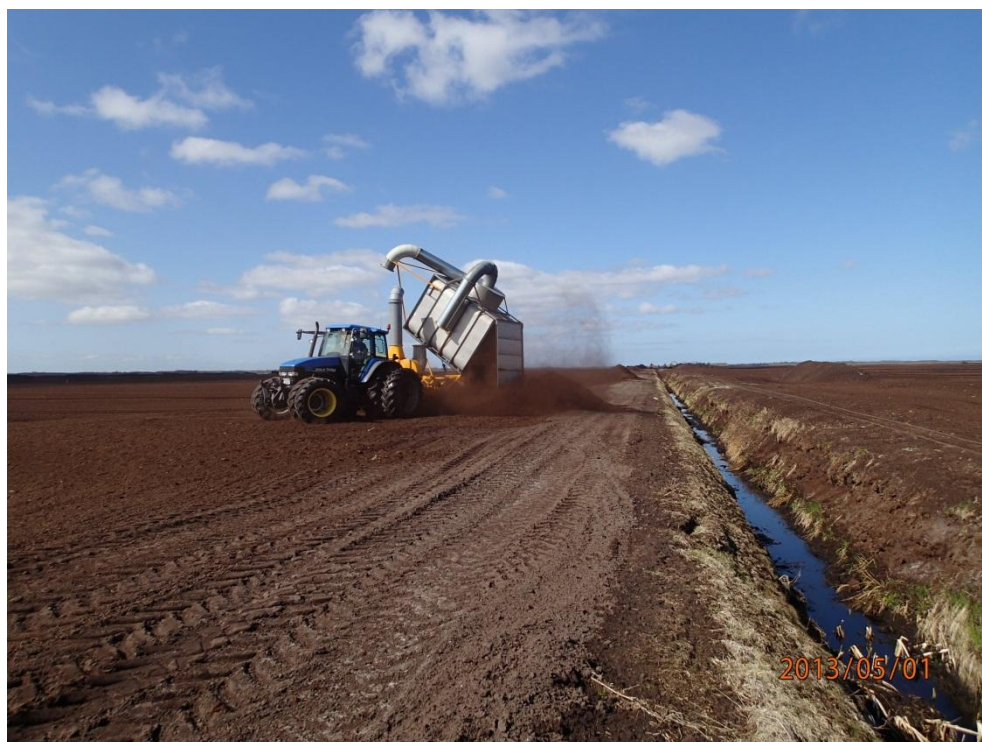
Figur 4-3 Tømning af vacuumhøster.
