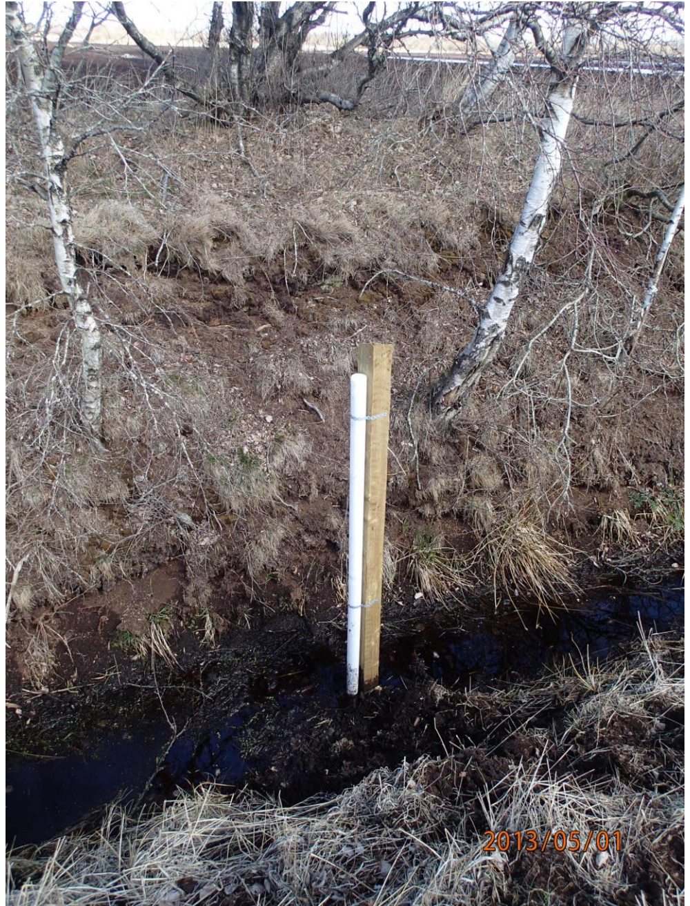
Figur 8-2 Vandstandslogger i en af hovedgrøfterne.
