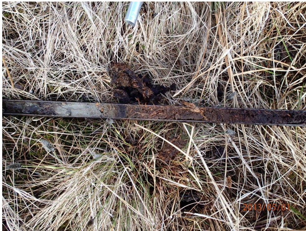
Figur 8-3 Tørveboring som fra venstre mod højre viser det grå sandlag (mineraljord), skovtørv med rester af rødder og vedplanter samt sort kærtørv.
