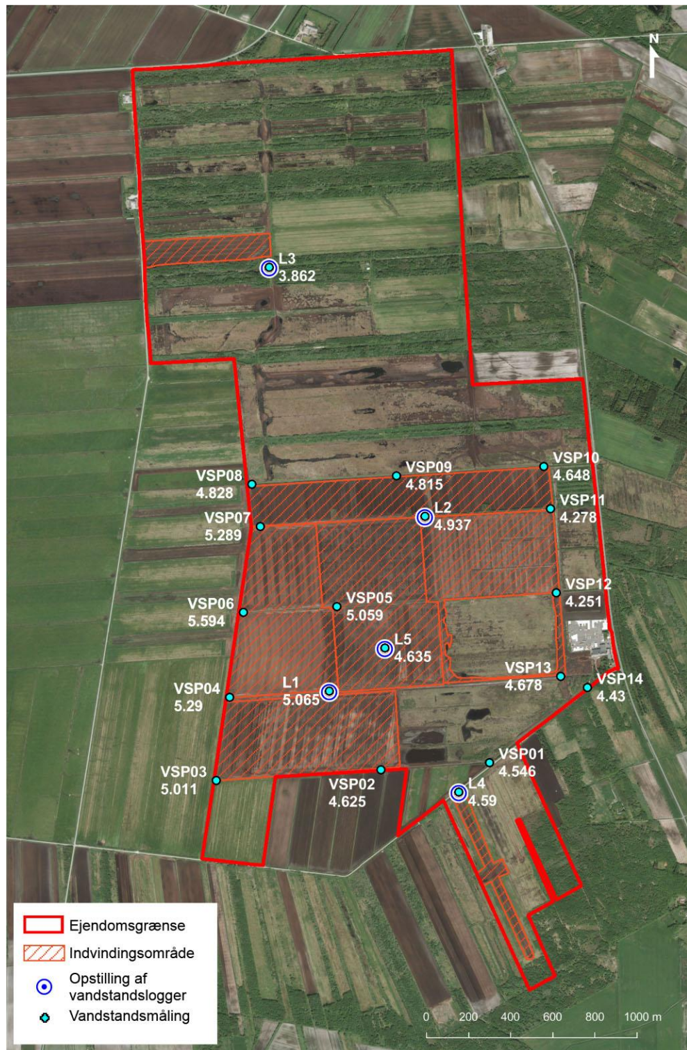
Figur 8-11 Vandspejlsmålinger i udvalgte grøfter april 2013 og placering af dataloggere
